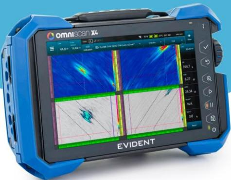
In questo webinar mostreremo le principali novità dell'OmniScan X4, come i "canali gemelli" per ispezionare con due sonde Phased Array contemporaneamente con TFM e PCI, la raccolta di file FMC per il post-processing dei dati o una maggiore velocità di ispezione (3 volte più veloce).
